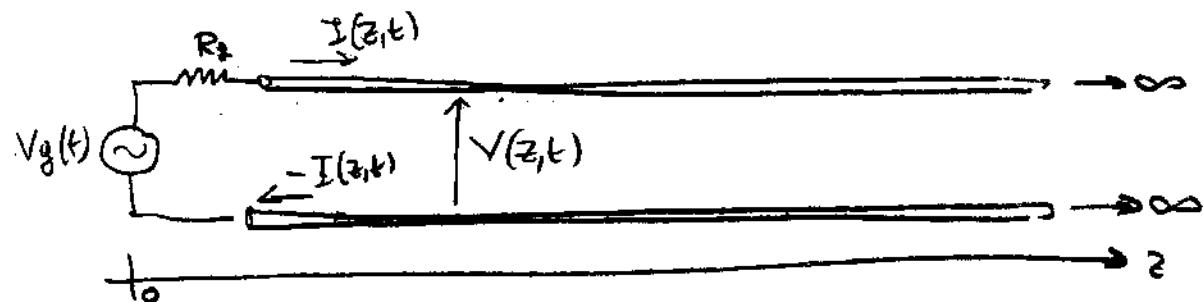
Il generatore impone una differenza di potenziale tra i due conduttori, che sarà uguale  $C_0 + \epsilon_0 \partial V / \partial z$  e anche l'eccitatore ha corrente  $I(t)$  sul conduttore superiore e  $-I(t)$  sul conduttore inferiore in modo che la corrente sia costante sul generatore.
